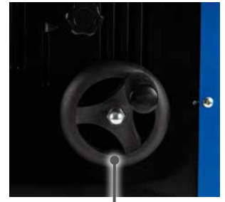
Réglage hauteur d'arbre par manivelle
