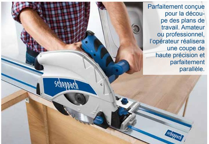
Parfaitement conçue pour la découpe des plans de travail. Amateur ou professionnel, l'opérateur réalisera une coupe de haute précision et parfaitement parallèle.
