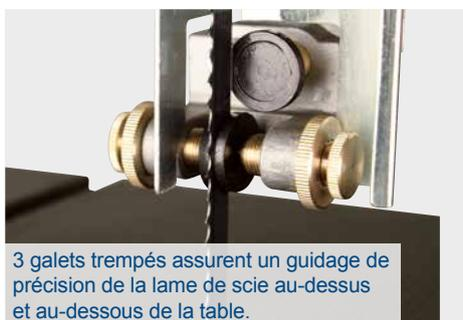
3 galets trempés assurent un guidage de précision de la lame de scie au-dessus et au-dessous de la table.
