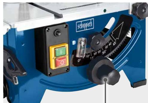
Volant de réglage de la lame en hauteur et en inclinaison
