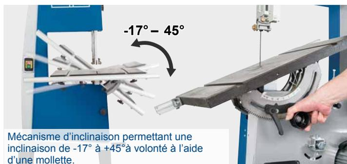
Mécanisme d'inclinaison permettant une inclinaison de  $-17^\circ$  à  $+45^\circ$  à volonté à l'aide d'une mollette.
