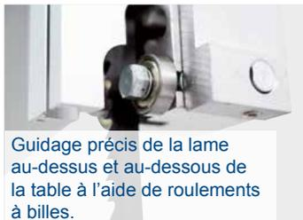
Guidage précis de la lame au-dessus et au-dessous de la table à l'aide de roulements à billes.
