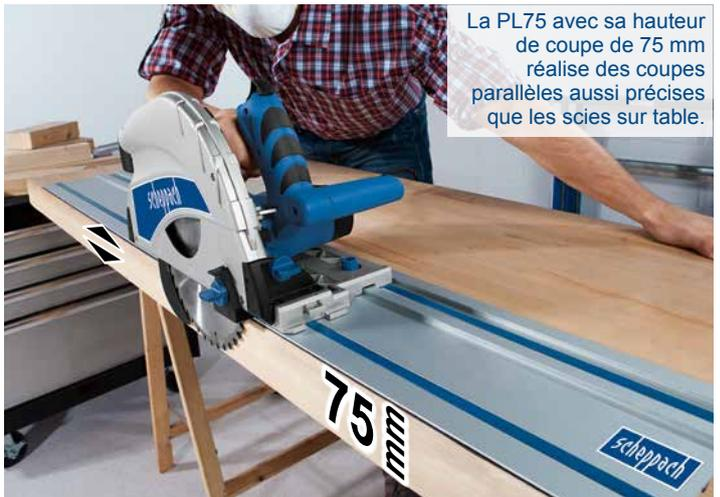
La PL75 avec sa hauteur de coupe de 75 mm réalise des coupes parallèles aussi précises que les scies sur table.
