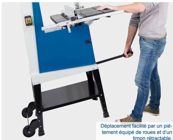
Déplacement facilité par un piétement équipé de roues et d'un timon rétractable.
