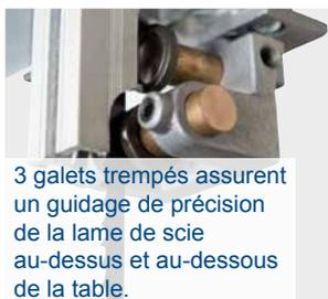
3 galets trempés assurent un guidage de précision de la lame de scie au-dessus et au-dessous de la table.
