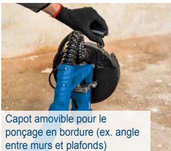
Capot amovible pour le ponçage en bordure (ex. angle entre murs et plafonds)
