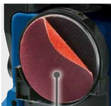
Plateau de ponçage avec revêtement auto-agrippant
